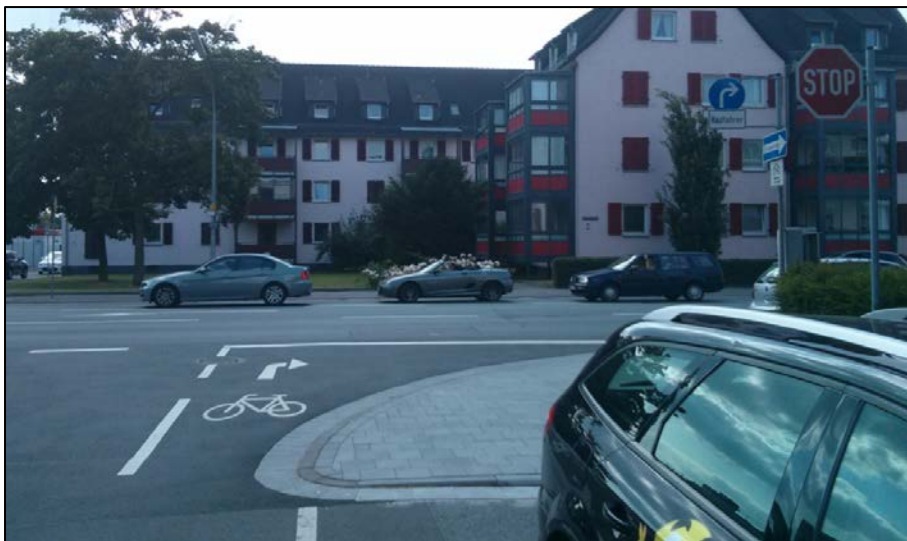
Abbildung 14: Beispiel einer Fahrradporte mit passender Beschilderung [6]
