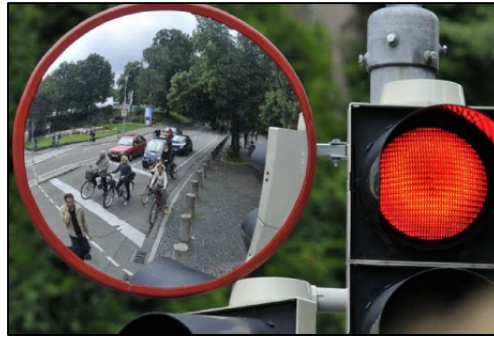
Abbildung 21: Trixi-Spiegel zur Sichtfeldverbesserung im „Toten Winkel“ [7]
